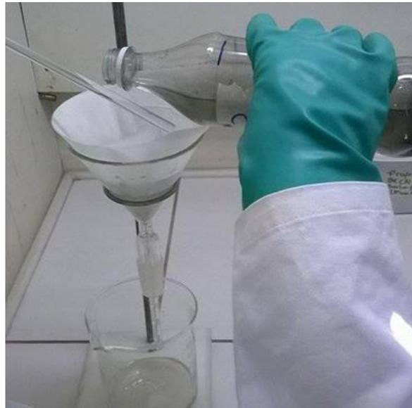
**Figura 2.** Filtração realizada em capela com o uso de papel filtro.
