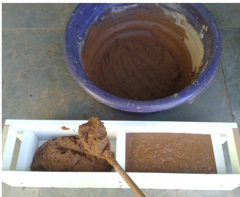
Figura 9: Acomodando-se o compósito no segundo compartimento do molde de madeira para fabricação do segundo tijolo ecológico.
