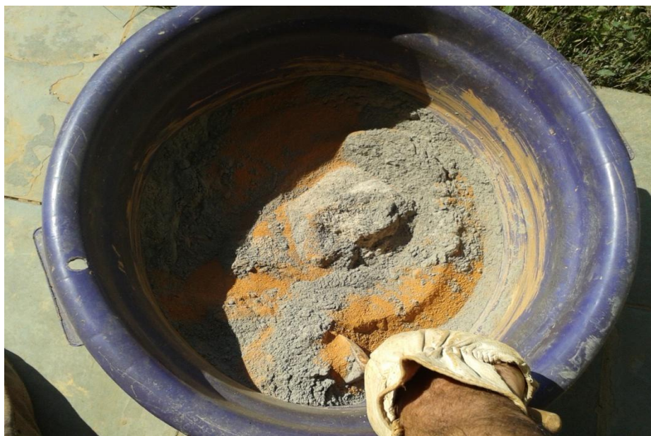
Figura 3: Terra seca e areia fina peneiradas e cimento peneirado sendo revolvidos com colher de pau.
