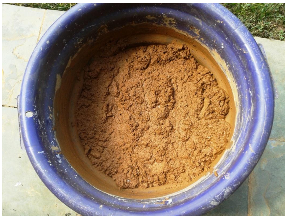
Figura 7: Composto de terra e areia peneiradas, cimento peneirado e pasta de papel.
