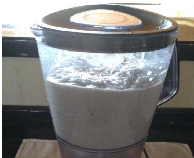
Figura 2: Pasta homogênea de papel triturado no liquidificador.
