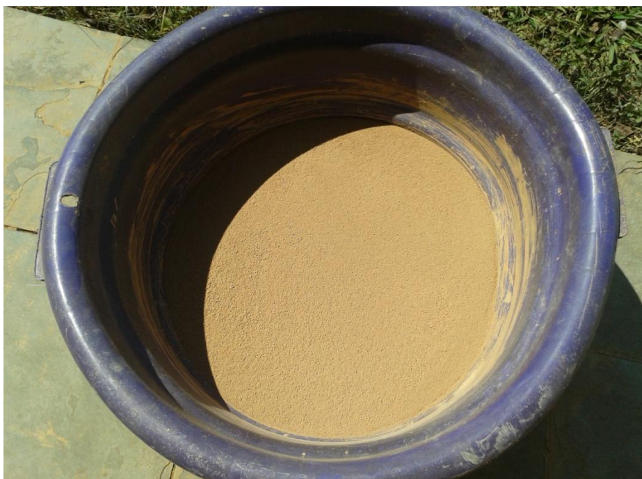
Figura 4: Mistura homogênea de terra seca e areia fina peneiradas e cimento peneirado.
