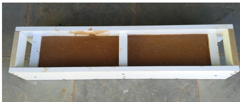
Figura 10: Compósito acondicionado após bater contra o chão com o molde de madeira para a fabricação de dois tijolos ecológicos.
