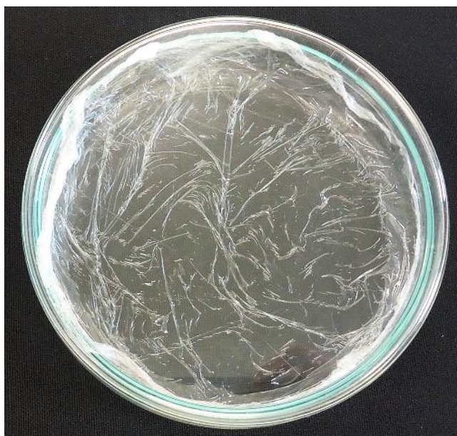
Figura 1. Superfícies de placas de Petri moldadas com polietileno para a formação e secagem dos biofilmes de quitosana.
