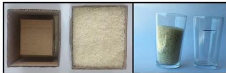
Figura 7: Demonstração de como determinar a quantidade de borracha de silicone sem desperdício. Fonte: do autor, 2019).
