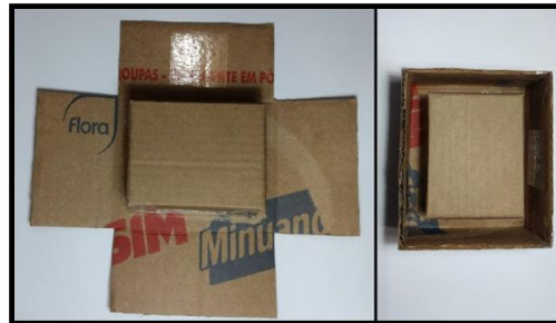
Figura 6: Montagem dos moldes para confecção das formas de silicone. (Fonte: do autor, 2019).
