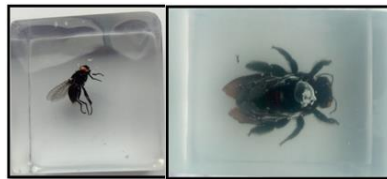
Figura 12: Peças em resina obtidas com a utilização de diluidor cristal, após a cura, lixamento e polimento. (Fonte: do autor, 2019).
