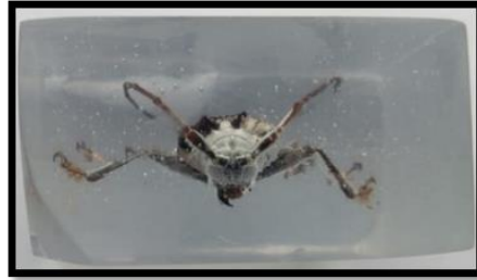
Figura 10: Resina acrílica após a cura na pressão e lixamento. (Fonte: do autor, 2019).
