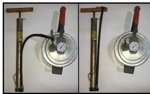
Figura 3: Passo a passo de como adicionar a pressão com auxílio de uma bomba de encher pneu. (Fonte: do autor, 2019).
