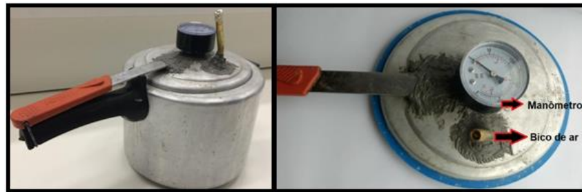
Figura 2: Panela de pressão adaptada com Manômetro e bico de pneu. (Fonte: do autor, 2019).
