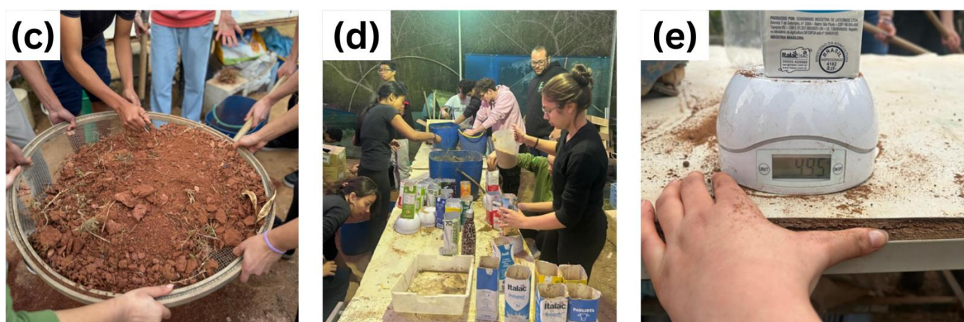
Figura 2 – Peneiração do solo (c), enchimento das caixas com as diferentes concentrações de solo (d), Pesagem das caixas (e).
