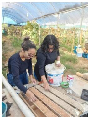
Figura 6. Suporte inclinado para a demonstração do processo erosivo em diferentes tipos de solo.
